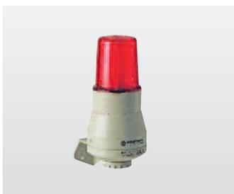
Alarm-Modul (optisch + akustisch), anschließbar an Base-Alarmrelais, Ø 70 x 164 mm, 24 V AC/DC / 320 mA, Dauerlicht: rot, Dauerton: Summer ca. 2,4 kHz (Netzteil 0554 1749 erforderlich)
