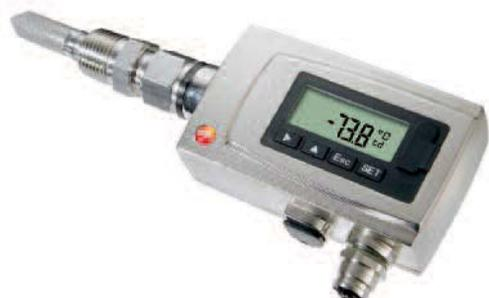
Der Messumformer testo 6781 wurde speziell für die Restfeuchtemessung in Druckluft und in trockener Luft (z. B. in Granulattrocknern) entwickelt. Die internationale Norm ISO 8573 bestimmt sieben Klassen von Druckluft-Qualität. Zur Einhaltung der höchsten Qualitätsklassen 1 und 2 sind leistungsstarke Adsorptionstrockner nötig. Deren
