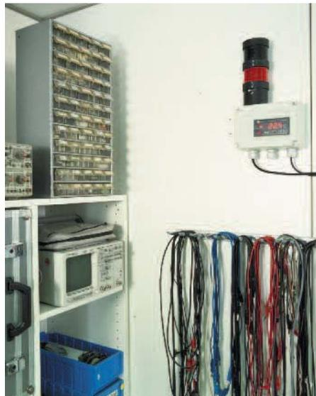
Die beiden Relaisausgänge des testo 54 ermöglichen dezentrale Alarme bei Grenzwertüberschreitung, z.B. mit Hilfe der Alarmsäule.
