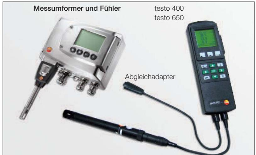
1-Punkt-Abgleich vor Ort mit dem Handgerät testo 400 oder testo 650 mit Präzisionsfeuchtefühler und Abgleichadapter
