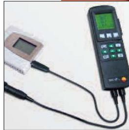
Abgleich vor Ort schnell und präzise mit Handmessgeräten testo 400/testo 650
