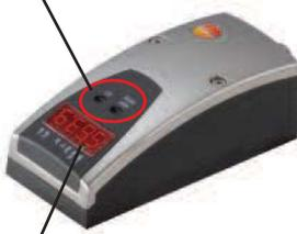
**Gut lesbares LED-Display (Anzeige um 180° drehbar)**
